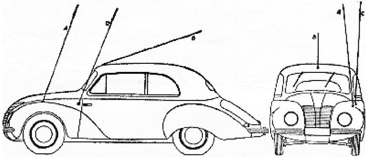
Abb. 2 Anbringungsmöglichkeiten für die Autoantenne
